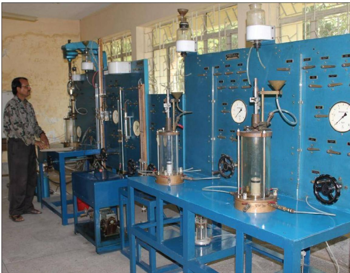
Triaxial Shear Test Apparatus এর মাধ্যমে Cohesion, Angle of internal friction নির্ণয় করা হয় যা Construction এর Design এ ব্যবহৃত হয়
