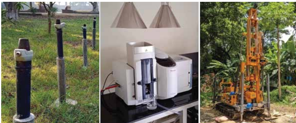
ছবি ১: (বাম দিক হতে) বাংলাদেশের বিভিন্ন স্থানে ৯০৫টি অটোমেটেডকৃত পর্যবেক্ষণকূপের ১টি গুচ্ছকূপ; পানির গুণাগুণ পরিমাপের জন্য ল্যাবরেটরীতে স্থাপিত এটমিক এবসরপশন স্পেকট্রোফটোমিটার; বিভিন্ন অবকাঠামোর নকশা প্রণয়নের লক্ষ্যে ভূ-কারিগরি অনুসন্ধানের জন্য সংগৃহীত ড্রিলিং রিগ।
